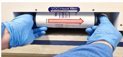
Slika 12.2 Postopek vstavljanja in odstranjevanja filtra VOC/HEPA
