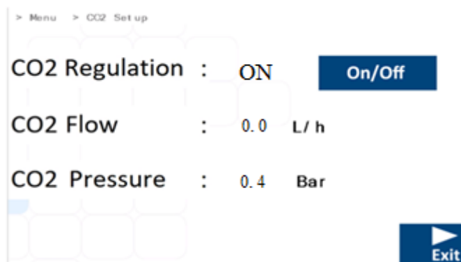
Slika 16.2 Pogled podmenija Nastavitev CO 2 na večprostorskih inkubatorjih za IVF MIRI® TL6 in MIRI® TL12
