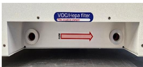
Slika 12.1 Puščica smeri pretoka na večprostorskih inkubatorjih za IVF MIRI® TL6 in MIRI® TL12
