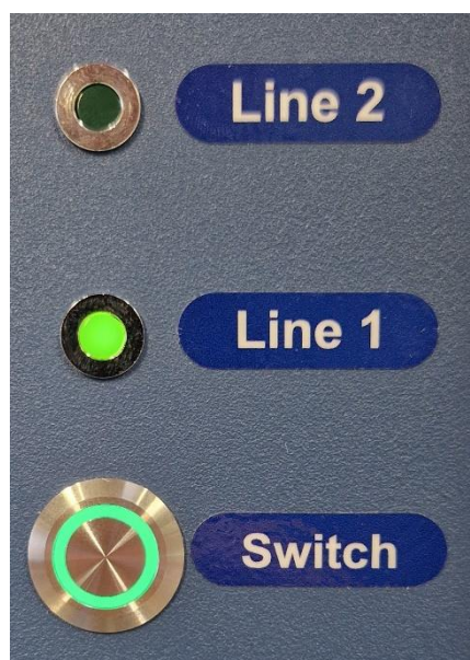
Slika 20.2 Stikalo za preklop linije na večprostorskem inkubatorju za IVF MIRI® TL12 in aktivna linija 1
